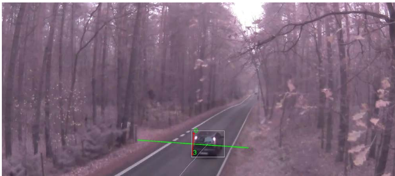
Rys. 4. Przykładowa klatka z filmu demonstrująca działanie systemu automatycznego zliczania pojazdów.
