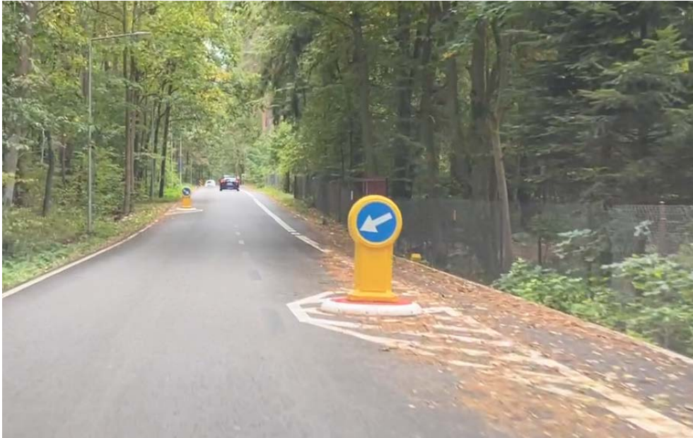
Zdjęcie 12 szykana (na pierwszym planie znak C-10, po lewej w oddali znak C-9)
